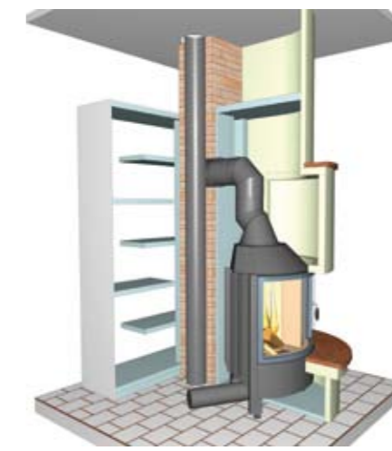
Rez hypokaustového krbu s krbovou vložkou SPARTHHERM. Aj krb s krbovou vložkou SPARTHHERM a BRUNNER je možné postaviť ako hypokaust.
